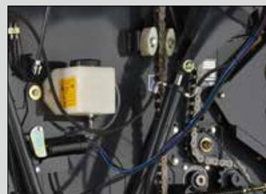
Sistema automático de lubrificação de correntes
