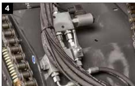
Controle de faca separada/DROPFLOOR, ativado a partir da cabine do trator
