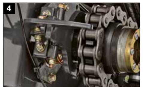
Desengate mecânico do rotor
